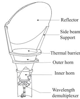
Fig. 10 Antenna reflector of CS-2.
