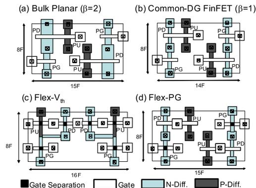
Fig. 10 Proposed layouts for the SRAM cell; (a) bulk planar, (b) CDG-FinFET, (c) Flex- $V_{th}$ , (d) Flex-PG.
